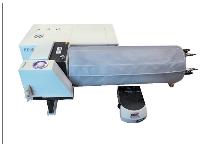
Рис.1. ИК-фурье-спектрометр ФТ-801 с термостатированной 20 м газовой кюветой фирмы PIKE и контроллером температуры. На фото справа кювета закрыта терморубашкой
