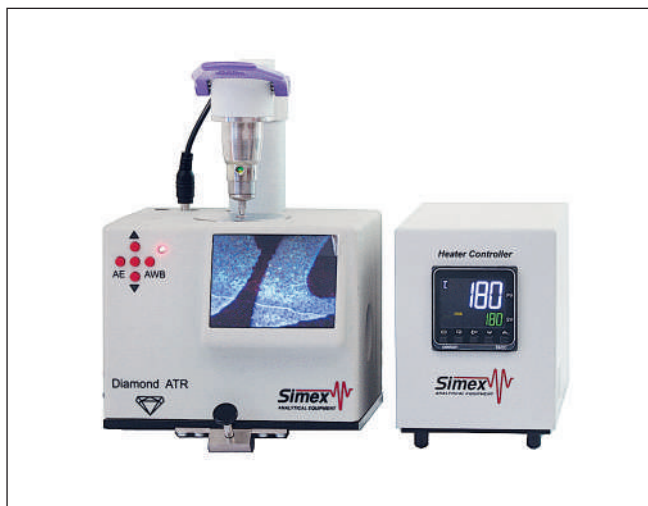
Рис.7. Приставка НПВО-А с термоячейкой, справа – контроллер температуры
