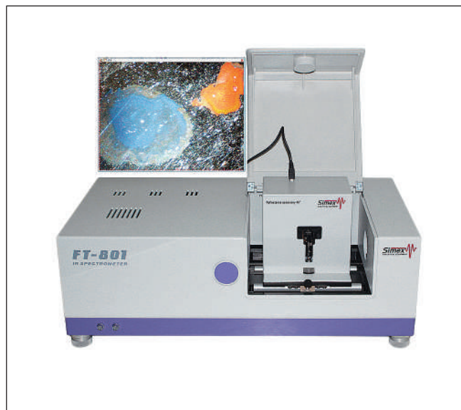
Рис.1. Приставка ПРИЗ в кюветном отсеке, слева сверху – изображение объекта на мониторе компьютера
