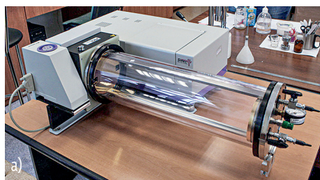
Рис. 1. Система для газового анализа на базе спектрометра ФТ-801 с многопроходной импортной газовой кюветой с оптическим ходом 20 м, высокочувствительным охлаждаемым МСТ-детектором без нагрева (а) и с нагревом (б)
