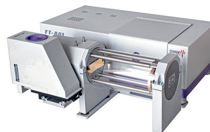
Рис. 2. Система для газового анализа на базе ФТ-801 с газовой кюветой (оптический ход 4,8 м) и охлаждаемым МСТ-детектором
