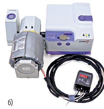
Рис. 4. Система для газового анализа на базе фурье-спектрометра ФТ-805 с обогреваемой газовой кюветой 4,8 м и термоконтроллером. Детектор: пироэлектрический (а) или высокочувствительный охлаждаемый МСТ (б)
