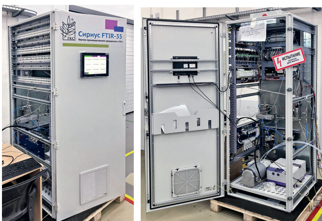
Рис.3. Система для газового анализа на базе спектрометра ФТ-805 в составе опытного образца газоанализатора "Сириус FTIR-35"
