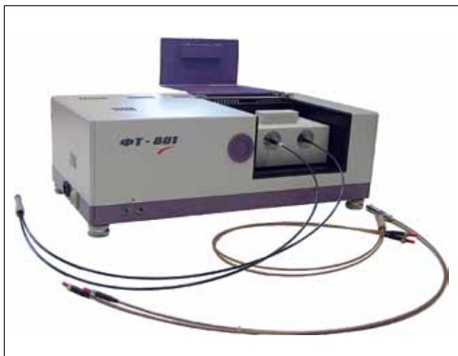
Рис.7. ИК фурье-спектрометр "ФТ-801" с каплером (устройством согласования волокна со спектрометром) и ИК-оптоволоконными зондами (сменные наконечники из ZnSe, полученные химическим осаждением из газовой фазы)
