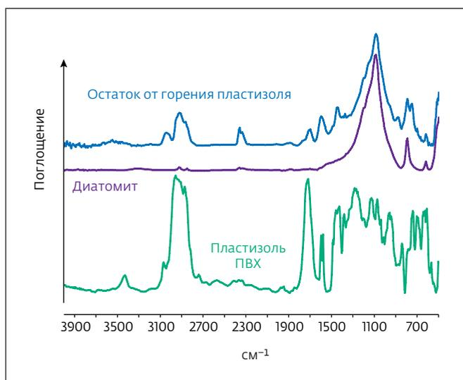
Рис.7. ИК-спектры пропускания тонкого среза пластизоля ПВХ, диатомита и поверхностного слоя остатка от сгорания наполненного диатомитом пластизоля (пробы в виде прессованной таблетки с КВг)
