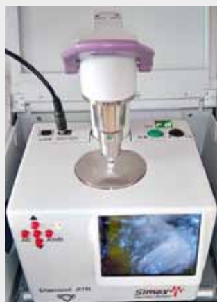
Приставка НПВО-А-УФ в кюветном отсеке фурье-спектрометра
