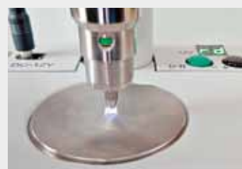
Прижим с образцом в процессе фотополимеризации
