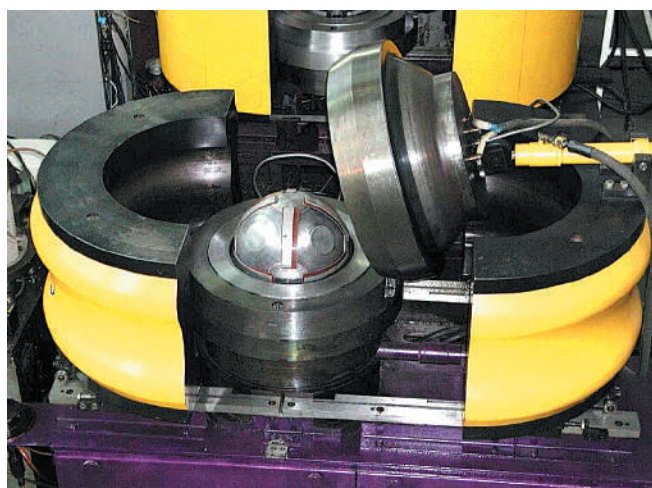
Рис.2. Установка высокого давления БАРС для выращивания кристаллов алмаза
