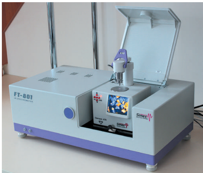
Рис.1. ИК-фурье-спектрометр ФТ-801 с приставкой НПВО-А
