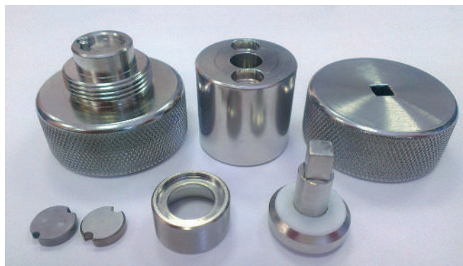
Рис.6. Мини-пресс в разобранном виде
