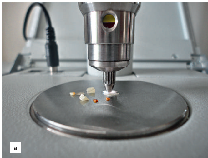
Рис.5. Пластика янтаря на алмажном элементе НПВО под прижимом (а), увеличенное изображение той же пластинки, полученное со встроенной в приставку видеокамеры (б)
