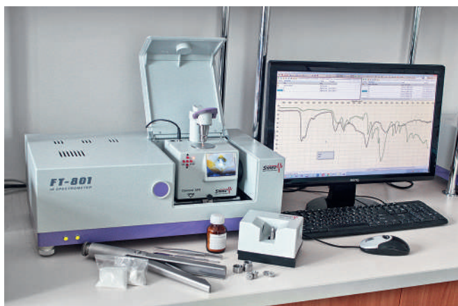
Рис.2. Спектральный комплекс для анализа янтаря: фурье-спектрометр ФТ-801 с алмазной приставкой НПВО в кюветном отсеке, приставка фокусирующая, ручной пресс, аксессуары
