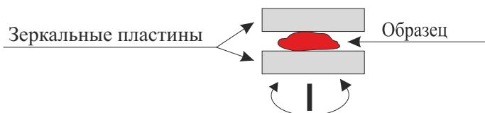
Предназначен для пробоподготовки при исследованиях образцов с помощью ИК микроскопа и приставок зеркального отражения.
