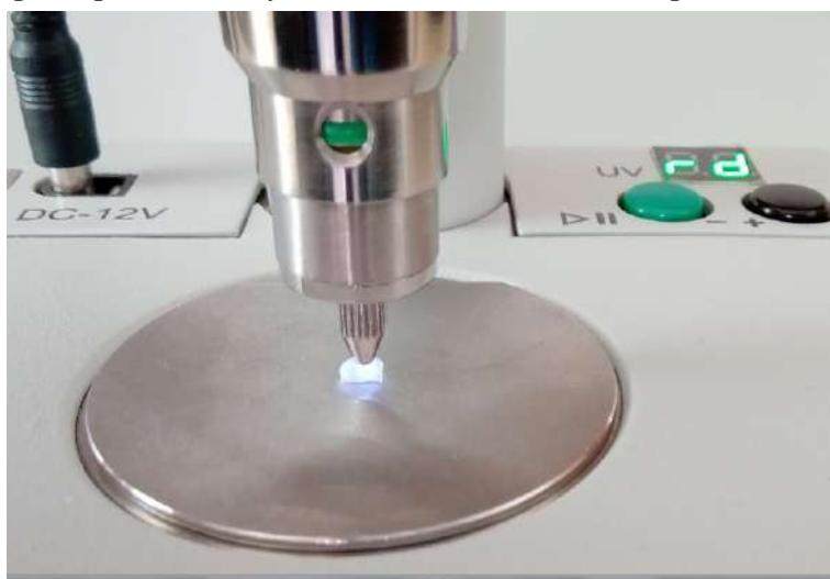
Для регистрации спектров зеркального и диффузного отражения (ЗДО) применяется сменный столик. Образец располагается на предметной плоскости исследуемой поверхностью вниз. Метод используется для определения спектральных характеристик оптических деталей, тонких пленок на поверхности, кристаллов, прочих крупных цельных объектов произвольной формы и размера.
