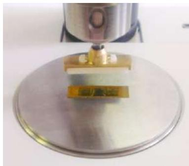
В зависимости от размера, геометрии и прочих свойств образца можно регистрировать спектр как в режиме МНПВО (положение наконечника показано на рисунке слева), так и в режиме однократного полного внутреннего отражения – при контакте поверхности только с центральной частью призмы (положение наконечника показано на рисунке справа).
