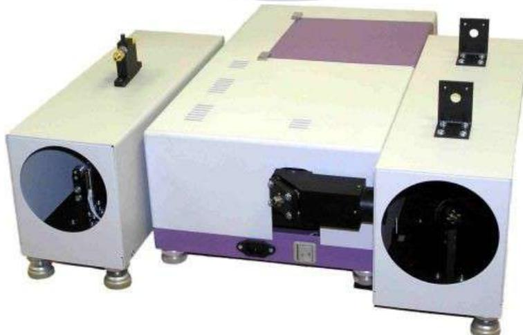
Состоит из сопряженного с фурье-спектрометром зеркального телескопа и прожектора с ИК излучателем. Используется для регистрации спектров газовых и аэрозольно-газовых смесей на трассах длиной до 100 м. Диаметр главного зеркала телескопа 170 мм и угловое поле зрения +/- 3 град. В комплект может быть включен дополнительный отражатель.
