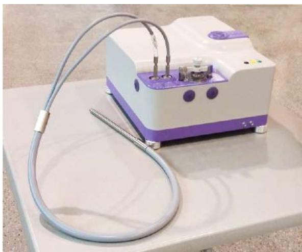
ИК фурье-спектрометры ФТ-805 позволяют эффективно использовать световодные системы (в том числе две пары зондов одновременно).
