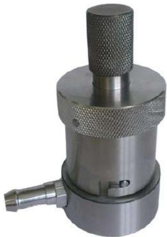
Предназначена для изготовления таблеток, состоящих из исследуемого вещества и микрокристаллического бромида калия (KBr). Пресс-форма используется в комплекте с гидравлическим прессом ГП 200-13.
