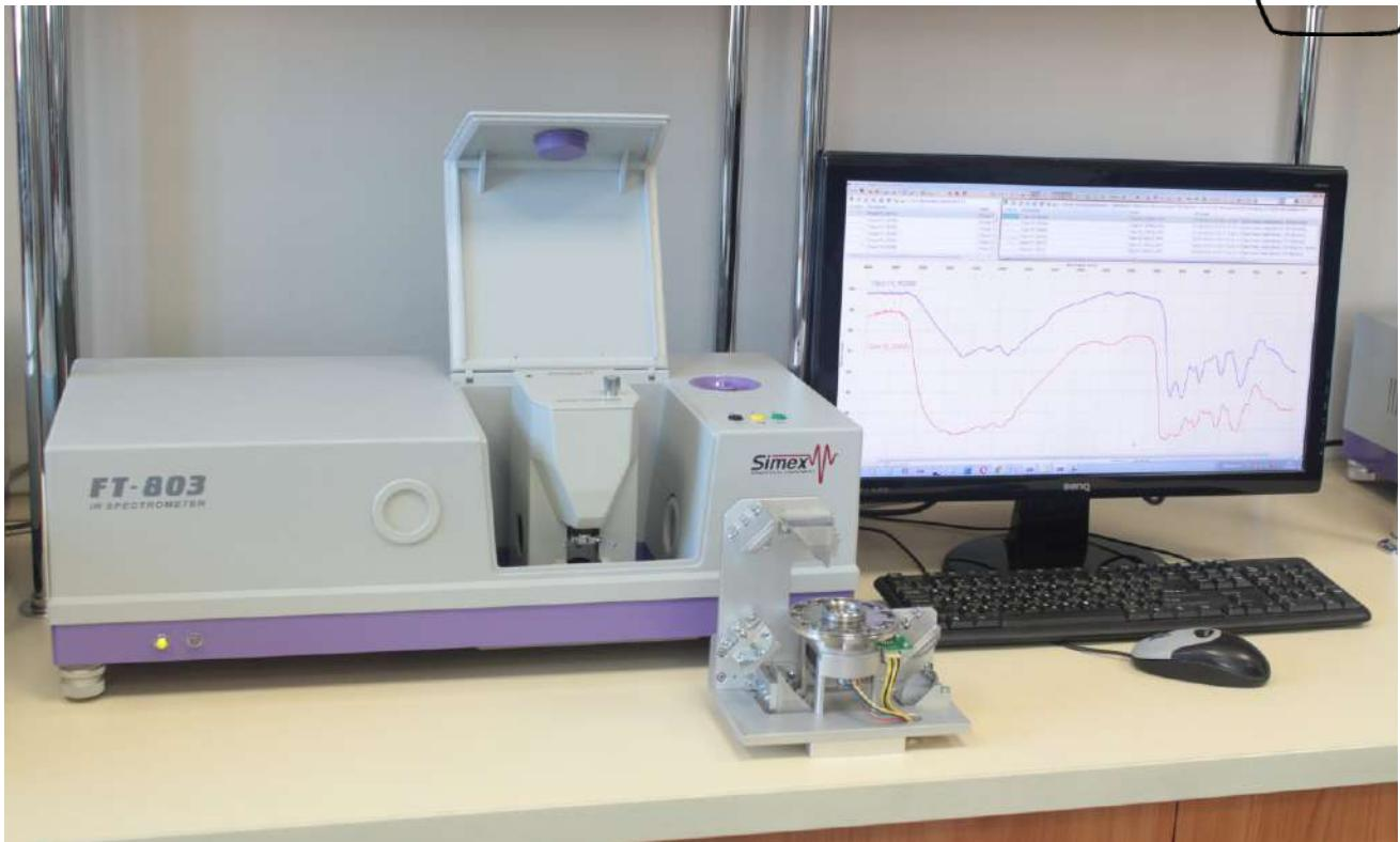
ФТ-803 – лабораторный прибор исследовательского уровня, герметичный, с увеличенным разрешением и чувствительностью, с портами для подключения внешних устройств, с возможностью установки нескольких внутренних детекторов - по выбору клиента, включая высокочувствительный МСТ.
