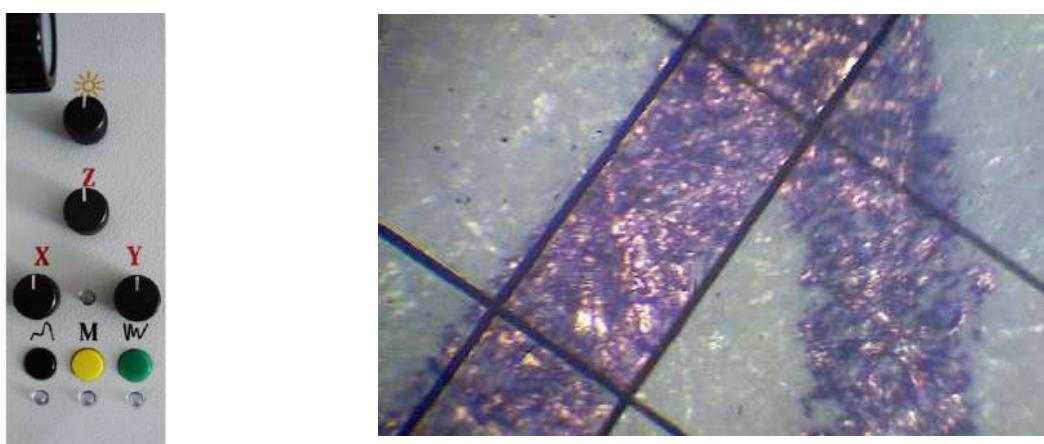
Оператору достаточно задать шаг сканирования, размер зоны фотометрирования (диафрагмы), общий размер исследуемой площади образца, а также расположение характерных полос в спектре. Результатом автоматической работы спектрального комплекса является плоская или трехмерная карта поверхности, содержащая сведения о химическом составе, набор соответствующих спектров и оптических изображений объекта.
